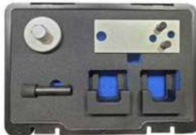
REF. WT1722 COFFRET DE CALAGE DE DISTRIBUTION MERCEDES BENZ 1.6L ET 2.0L DIESEL M654
