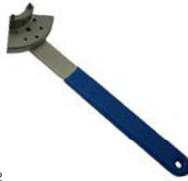
REF. WT9002 CLE TENDEUR MOTEUR VAG - OEM T10020 - POIGNEE 5 SENS REGLABLE ET PIVOTANTE A 180° - RECOMMANDEE POUR LES COURROIES DE DISTRIBUTION SUR LES 4 ET 5 CYLINDRES VAG ET LES POMPES VAG T4 SERVO
