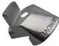
REF. 9G0808 OUTIL (DE)MONTAGE COURROIE ELASTIQUE - UNE FACE MAGNETIQUE MAINTIENT L'OUTIL EN PLACE SUR LA POULIE - PREVENT LES DOMMAGES SUR LA COURROIE - AVANT ET ARRIERE
