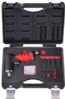
REF. 909G6 CLE A CHOCS POUR BOUGIES DE PRECHAUFFAGE (9PC) - PERMET DE RETIRER LES BOUGIES BLOQUEES OU GRIPPEES SUR UN MOTEUR DIESEL - 4 REGLAGES DE COUPLES 10 20 30 ET 40NM - COMPREND 5 DOUILLES IMPACT 8 9 10 11 12MM, 2 RALLONGES ET UN CARDAN UNIVERSEL
