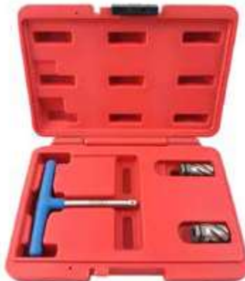
REF. WT6003 ALESOIRS POUR CAPTEURS ABS - POUR NETTOYER LE TROU DU CAPTEUR ABS SUR LE MOYEU - ALESOIRS DIAM 15MM X 23MM ET DIAM 18MM X 23MML - POIGNEE EN T 1/4"
